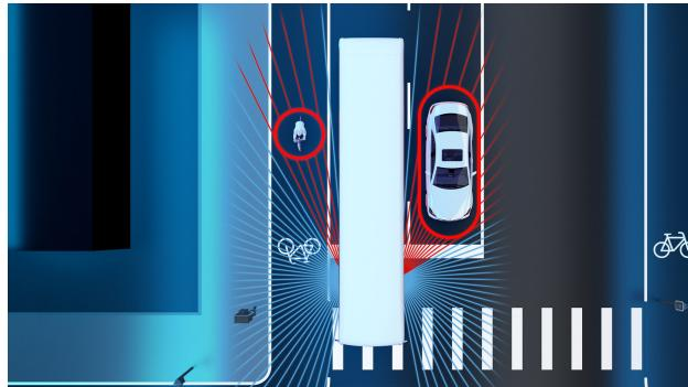
Le Sideguard Assist 2 est un système d'assistance à la sécurité qui assiste en permanence le conducteur des deux côtés dans les situations critiques de changement de direction où la visibilité peut être réduite. Lors de changements de direction ou de changements de voie, le système a pour but d'aider, dans le cadre des limites du système, à éviter les situations critiques ou à atténuer les conséquences de l'accident.
