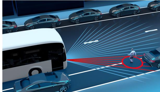
Con il Preventive Brake Assist 2, Daimler Buses offre per gli autobus urbani la seconda generazione del Brake Assist attivo. Il sistema avverte in caso di collisioni con pedoni e ciclisti in movimento, nonché con oggetti fermi e in movimento. In caso di grave pericolo di collisione, il conducente viene avvisato da un segnale ottico e acustico e avvia automaticamente una frenata parziale.
