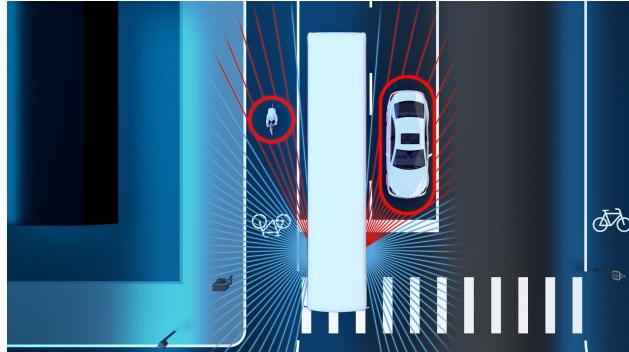
Il Sideguard Assist 2 è un sistema di assistenza per la sicurezza che supporta il conducente nelle situazioni critiche di svolta a destra o a sinistra che possono essere caratterizzate da visibilità limitata. Nelle svolte o nei cambi di corsia, il sistema aiuta a riconoscere, entro i limiti del sistema, gli ostacoli fissi o in movimento e ad avvisare il conducente per evitare situazioni critiche o ridurre le conseguenze di un incidente.
