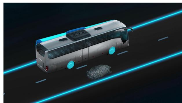
Das Elektronische Stabilitätsprogramm reduziert die Schleudergefahr deutlich, indem es zum Beispiel durch gezieltes Abbremsen einzelner Räder einem Ausbrechen des Fahrzeugs im Rahmen der physikalischen Grenzen entgegenwirkt.
