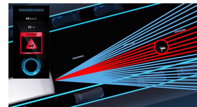
Der Notbremsassistent ABA 6 unterstützt den Fahrer durch eine automatisch eingeleitete Notbremsung bei drohender Gefahr von Auffahrunfällen auf vorausfahrende Fahrzeuge oder auf stehende Hindernisse. Er kann ebenfalls sich bewegende oder stehend bleibende Personen und Fahrradfahrer vor dem Fahrzeug erkennen. Das System kann darauf mit einer akustischen und optischen Warnung des Fahrers sowie einer automatisch eingeleiteten Teilbremsung bzw. einer Vollbremsung reagieren.
