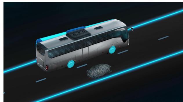
Das Elektronische Stabilitätsprogramm reduziert die Schleudergefahr deutlich, indem es zum Beispiel durch gezieltes Abbremsen einzelner Räder einem Ausbrechen des Fahrzeugs im Rahmen der physikalischen Grenzen entgegenwirkt.
