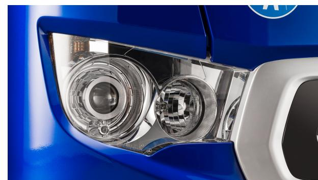
Bi-Xenon-Scheinwerfer bedeuten im Vergleich mit Halogenscheinwerfern eine bessere Ausleuchtung
