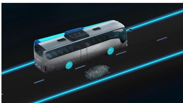
L'Electronic Stability Program riduce drasticamente il rischio di sbandamento, contrastando ad esempio lo sbandamento del veicolo entro i limiti fisici, attraverso la frenata selettiva di singole ruote.
