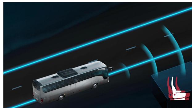
L'assistente mantenimento corsia (SPA) attenziona il conducente in caso di deviazione accidentale dalla corsia selezionata. Se c'è il rischio che il veicolo superi la linea di demarcazione, il conducente viene avvisato con una vibrazione sensibile del sedile.
