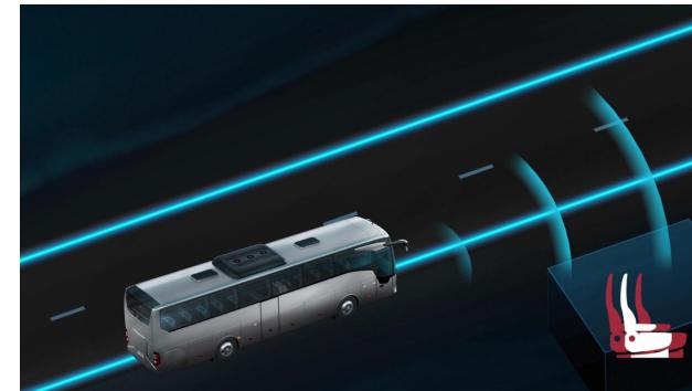
El asistente de carril SPA detecta si el vehículo abandona de forma imprevista el carril. Cuando el vehículo sobrepasa la señalización horizontal del carril, se advierte de ello al conductor mediante una vibración perceptible del lado correspondiente de su asiento.
