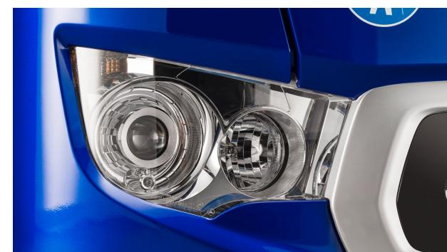
En comparación con los faros halógenos, los faros bixenón permiten una mejor iluminación de la calzada con un menor consumo de energía y una mayor vida útil.
