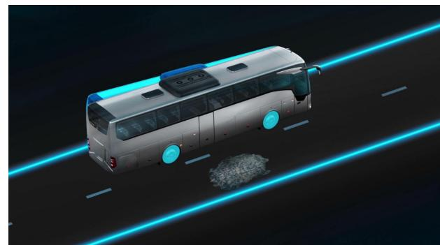
El programa electrónico de estabilidad reduce considerablemente el peligro de derrape, por ejemplo, frenando las ruedas de manera individual para contrarrestar el derrape del vehículo dentro de los límites físicos.
