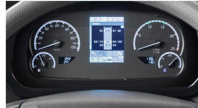
Die Reifendruckkontrolle TPM (Tire Pressure Monitoring) zeigt den aktuellen Druck in den einzelnen Reifen an und warnt bei Abweichungen vom optimalen Druck. Dies verringert den Verschleiß der Reifen, hat positiven Einfluss auf den Kraftstoffverbrauch und verhindert gefährliche Reifenschäden.
