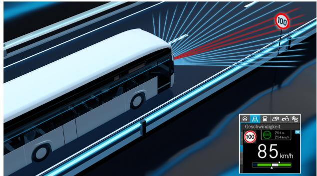
Der innovative Traffic Sign Assist bietet ein Höchstmaß an Sicherheit und Komfort auf der Straße. Dank GPS- und Kameraunterstützung wird die Fahrzeuggeschwindigkeit kontinuierlich mit den gültigen Verkehrsregeln verglichen.
