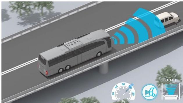
Le régulateur de vitesse et de distance Tempomat (ART) soulage le conducteur en maintenant automatiquement une distance constante définie par le conducteur par rapport au véhicule qui précède, sur la base de mesures effectuées en continu. Un système qui accroît non seulement la sécurité, mais aussi le confort de conduite, en particulier sur les routes nationales et les autoroutes.
