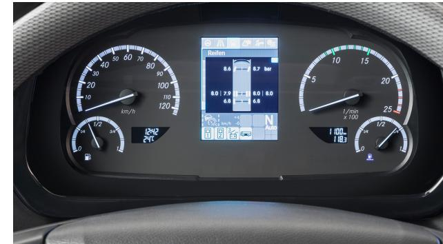
Le système de contrôle de la pression des pneus TPM (Tire Pressure Monitoring) affiche la pression instantanée dans chaque pneumatique et avertit le conducteur en cas de divergence par rapport à la pression optimale. Ce système a une incidence positive sur la consommation de carburant et permet de limiter l'usure ainsi que tout autre dommage grave sur les pneumatiques.
