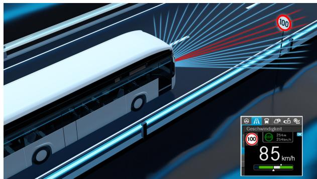
L'assistant de signalisation routière innovant offre un maximum de sécurité et de confort sur la route. La vitesse du véhicule est comparée en continu aux règles de circulation en vigueur grâce au soutien offert par le GPS et la caméra.
